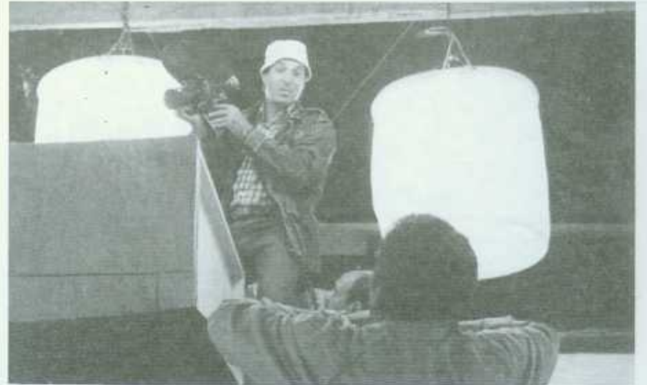
استعمال الاضاءة المنتشرة بالثرابا المعلقة داخل البلاتوه والاماكن المغلقة
