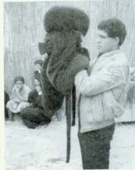
أحد وسائل كتم صوت الكاميرا اريفلكس التي ابتكرها المؤلف لأمكانية تسجيل الصوت في الشوارع والاماكن الحقيقية واللقطة لطلال ايمن ابو المكارم اثناء تدريبه مع المؤلف وتجربة الكاميرا.
